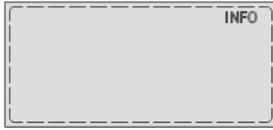
Im Hauptmenü "INFO" sind alle Informationen über eingestellte Grenzwerte, Verzögerungszeiten für Trip/Alarm und der gespeicherte Wert für den natürlichen Unsymmetriestrom zusammengefasst. In diesem Menü ist es nicht möglich die angezeigten Werte zu verändern. Um dieses Menü zu öffnen, mit der ▼ Taste das Menü "INFO" auswählen und mit der ► Taste das Menü öffnen. Die einzelnen Menüpunkte können mit den Tasten "▲" und "▼" ausgewählt werden.
