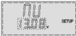
Um den Unsymmetriestrom zu speichern einmal ► drücken. Die zweite Zeile im Display blinkt und zeigt den aktuell gemessenen Wert an. Um den Wert zu speichern, erneut ► drücken. Soll der Wert neu gespeichert werden, einfach ► erneut drücken. Der gespeicherte Wert für den Unsymmetriestrom wird im
