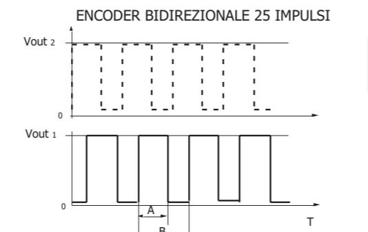
Encoder ottico monodirezionale a 50 impulsi giro o bidirezionale a 25 impulsi giro adattabile ai motori serie 615, 742, 752.
